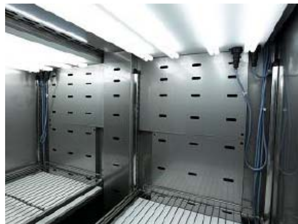
Opcjonalne źródła światła o zwiększonych osiągnięciach: 4 (lub 8) x 55W PLL
