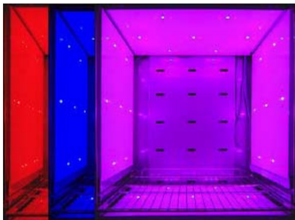
Opcjonalne źródło światła LED Flex Growth z możliwością regulacji natężenia dla danej długości fali
