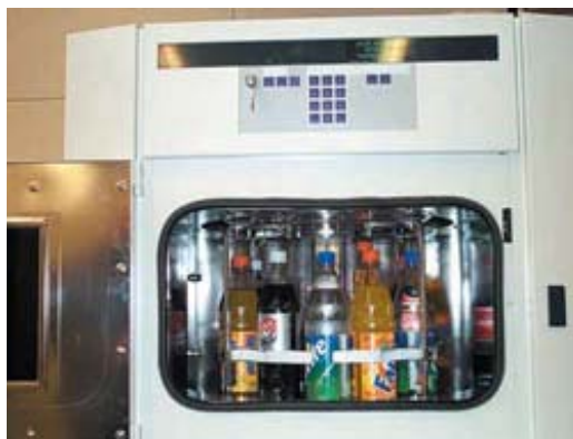
Specjalny kosz w komorze Xenotest Beta dla butelek o pojemnościach od 0,5 do 2 litrów
