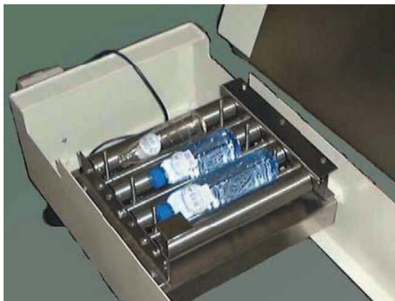
Podstawa aparatu Suntest XLS+ z systemem obracania butelek podczas testu
